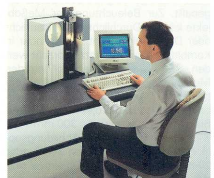
Rotationssymmetrische Teile mißt das computergestützte Meßgerät Profile 30. Auf dem Projektionsschirm kann die Werkstückkontur betrachtet werden
